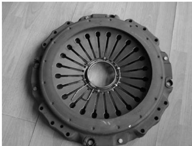
图3-1 拉式离合器压盘总成
