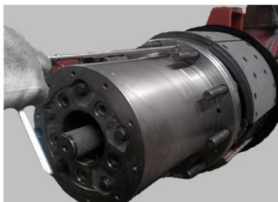
1) Снимаются крестообразные винты с потайной головкой и толкается колесный редуктор в сборе по диагонали с помощью 2 болта M10;
