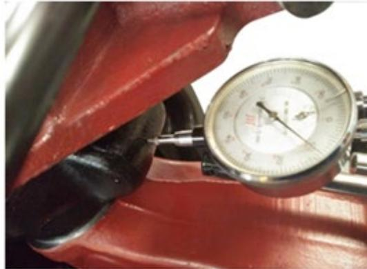
(2) 用千斤顶顶起前轴总成，使轮胎离地，1 个人沿工字梁轴向来回晃动轮胎，另一个人观察百分表指针变化量。
