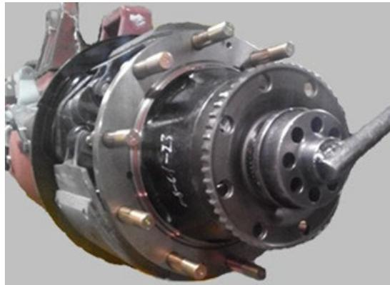
5) 松退第一个开槽圆螺母 $60^\circ\sim 90^\circ$ ，然后放入防松锁片；
