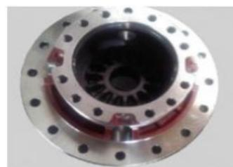
②在十字轴上依次装行星齿轮、行星齿轮垫片，然后装入差壳中；
