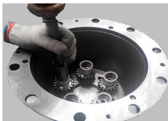
3) 在行星轮轴上套装止推垫片；
