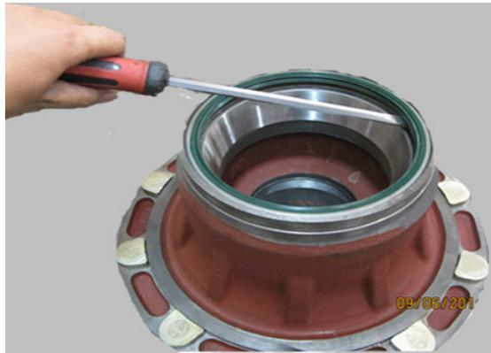
2) 用工具[8]和[5]拆下轮毂内轴承外圈；
