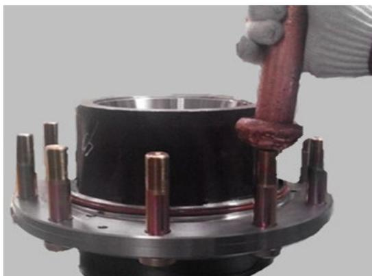
2) 在轮毂另一侧轴承孔内均匀涂一圈固持剂[e]，用工具[12]和[11]压装内轴承外圈到位；
