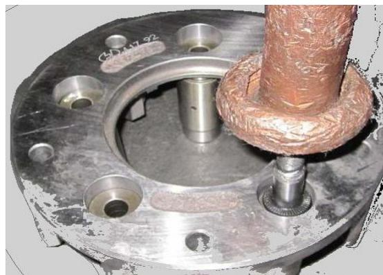
6) 压出行星轮，拆下滚针轴承。
