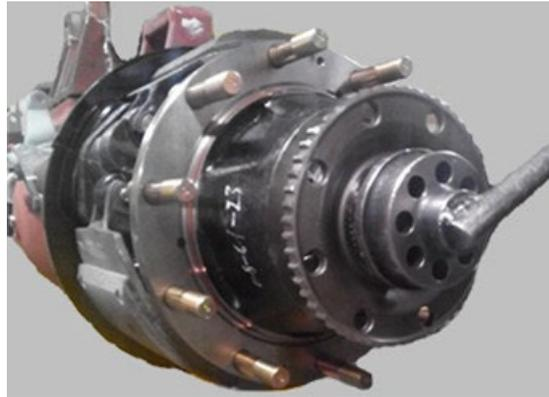
5) 拆卸齿圈支架;
