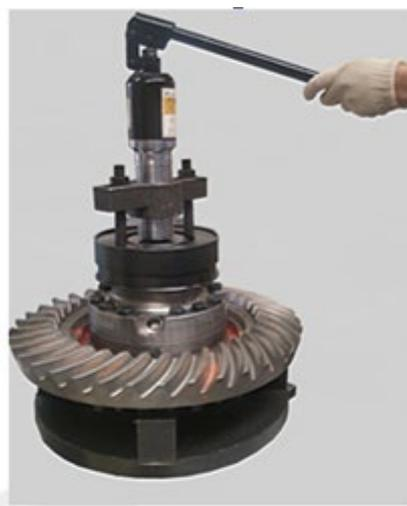
分别用工具拆下差速器齿面侧轴承内圈和齿背侧轴承内环；
