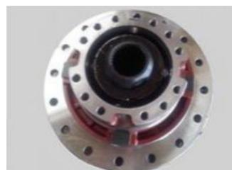
④装另一半壳到位，用两件对角螺栓连接，用专用检具检测齿面侧半轴齿轮轴向间隙: (0.25-0.5) mm，并对角拧紧差速器连接螺栓至力矩要求(310±15)Nm。
